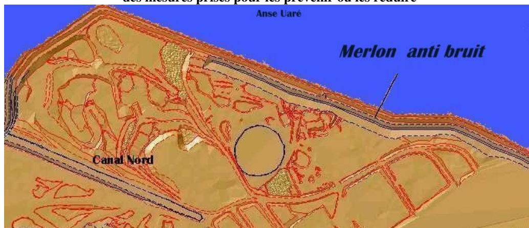
Figure 31 : Vue de l'aménagement anti-bruit le long de l'Anse Uaré.
