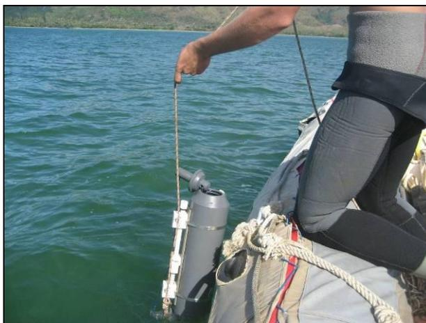
Figure 9 : Echantillonneur 5 litres pour les prélèvements d'eau
