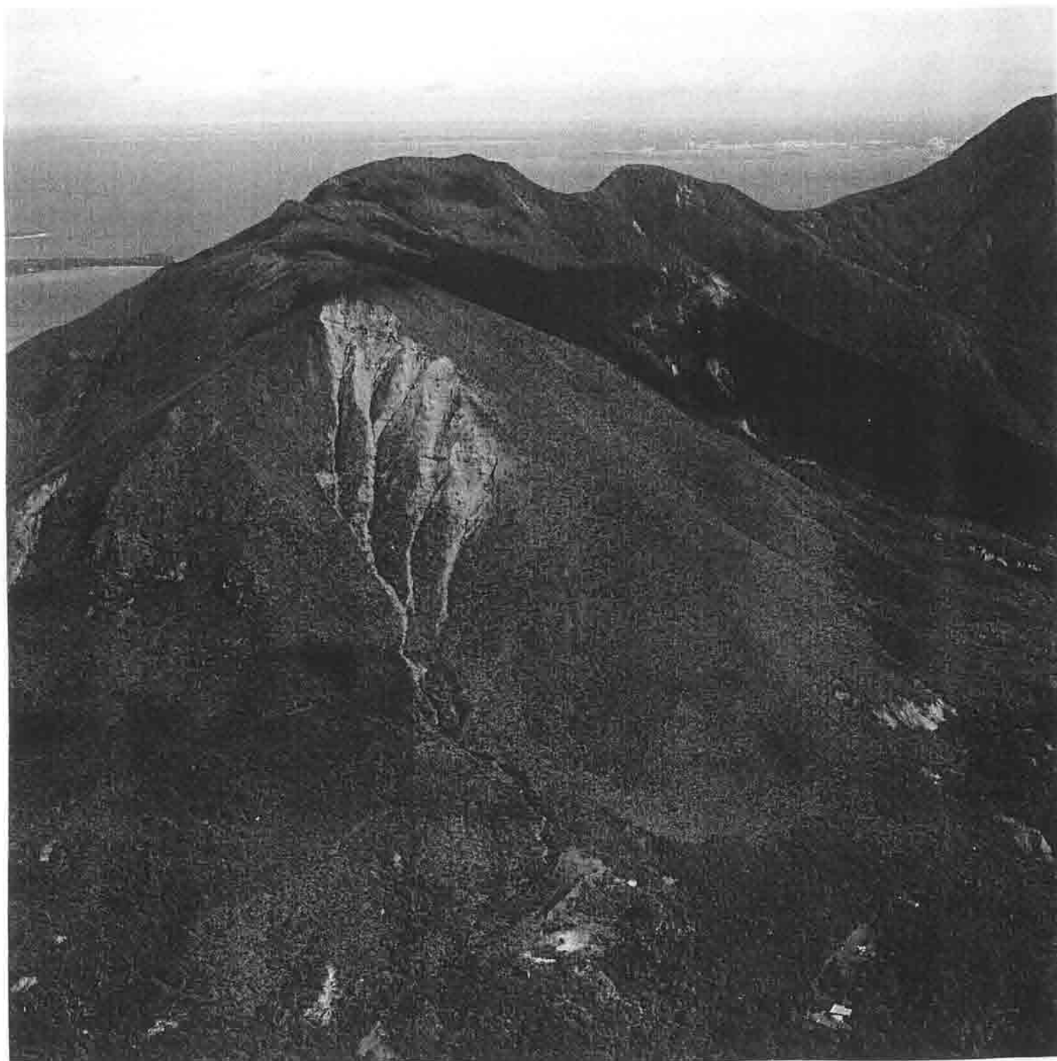
Photo 1 – Ensemble de coulées de débris essentiellement rocheux à l'extrémité est du massif. Les zones d'arrachement se situent dans un matériau saprolitique recouvert d'une mince couverture latéritique. Ces désordres étaient déjà visibles sur les photographies aériennes de 1942. Au second plan à droite, à la limite de l'ombre peut s'observer un phénomène identique.
