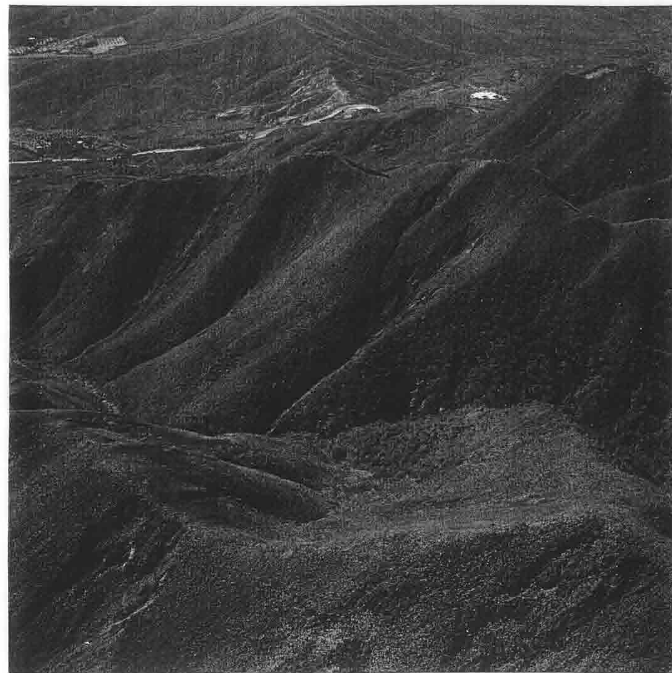
Photo 2 – Ensemble de niches d'arrachement et coulées de débris plus ou moins cicatrisées, constellant les flancs pentus de la vallée qui descend vers le lotissement industriel. Au centre coulée de débris en latérite et saprolite visible depuis au moins 1942 et toujours active. Au premier plan à gauche, ancienne coulée cicatrisée.
