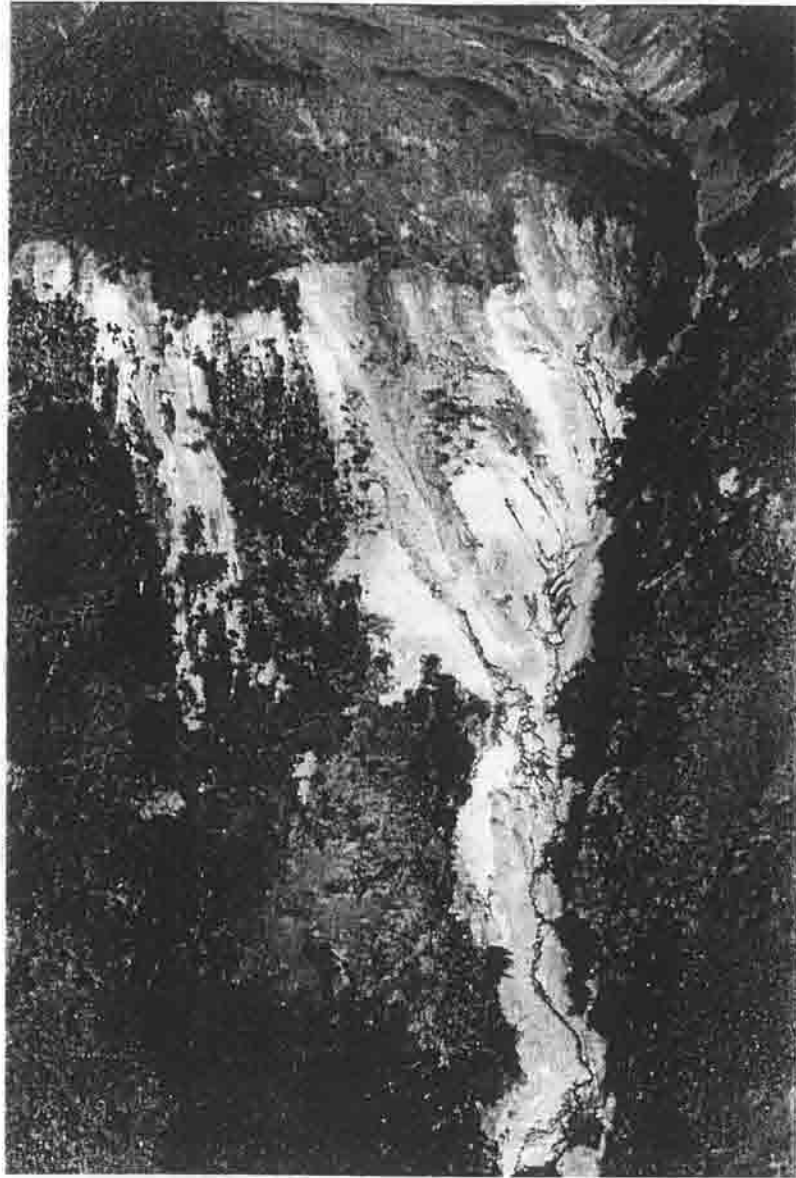
Photo 1 – Le front de départ des matériaux au lendemain du 12 janvier 1988. Les affaissements en marches d'escalier de la zone du glissement sont nettement visibles. De nombreuses excavations en forme d'entonnoir se sont ouvertes dans ce front et ont alimenté la coulée de débris qui a rempli le creek de la mine Dédé. Un alignement de sources est visible à la base de la zone instable et continue à alimenter la coulée, alors que le creek de la mine Dédé est déjà sec.
