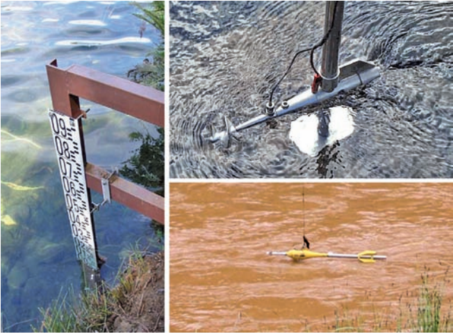
Échelle et support de sonde limnigraphique, courantomètre à hélice monté sur saumon et micro-moulinet, dispositif de jaugeages de hautes eaux
