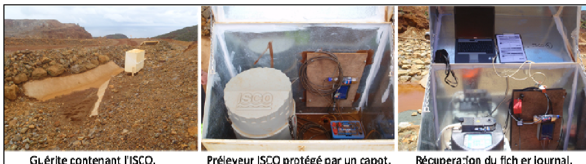
Figure 75 : Relevé in situ des préleveurs ISCO
