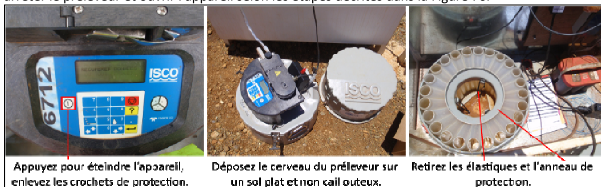
Figure 76 : étapes pour l'extraction des flacons du préleveur ISCO
