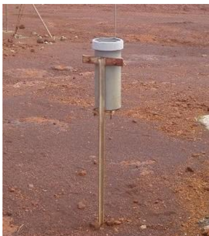
Figure 2 : Dispositif de collecte des eaux de pluie
