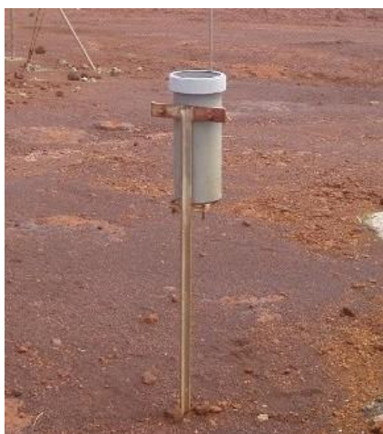
Figure 2 : Dispositif de collecte des eaux de pluie
