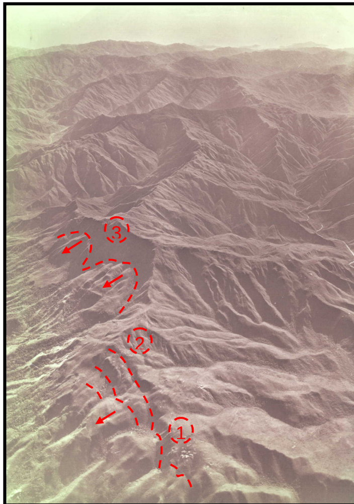
Figure 6 - Vue oblique depuis le Sud des anciens effondrements (trace des plans de détachement en rouge) sur le flanc ouest du massif du Sud au-dessus de Boulouparis (photo US Army, 1944).
