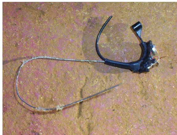
Figure 59. Un collier émetteur rongé et détruit, ce collier ne fonctionne plus.
