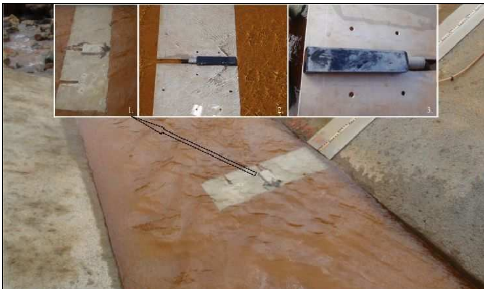
Figure 20 : Module 750 1. Obturation de l'appareil ; 2. Module 750 sans capot ; 3. Blanchiment du module
