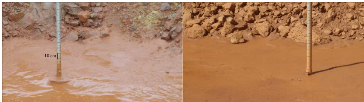
Figure 35 : Mesure du niveau des dépôts sur les perches dans FRN01
