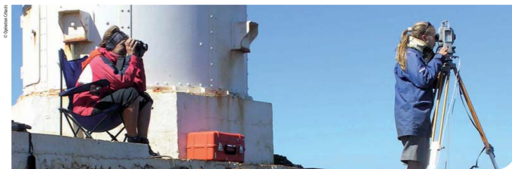
C'est avec un théodolite, instrument utilisé par les géomètres, que les experts recueillent des données sur la position, la vitesse et la trajectoire des baleines. Les mesures brutes, relevées toutes les minutes, sont ensuite traitées informatiquement.
