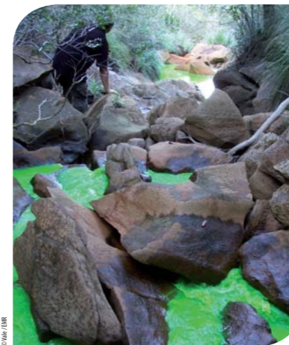
La fluorescéine est une substance colorée utilisée pour les opérations de traçage. Elle n'est pas dangereuse pour l'environnement et ne laisse pas de trace dans les milieux après son passage.
