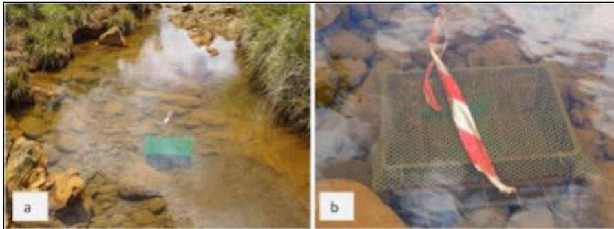
Figure 11: Fixation des cagettes sur la Baie Nord, 1er essai, station BAN11, a) à J+0, b) à J+17.
