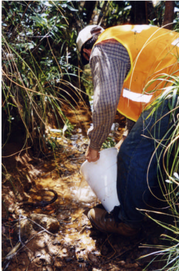
Photo 21: Injection du traceur dans le lit du ruisseau (14 déc. 2001)
