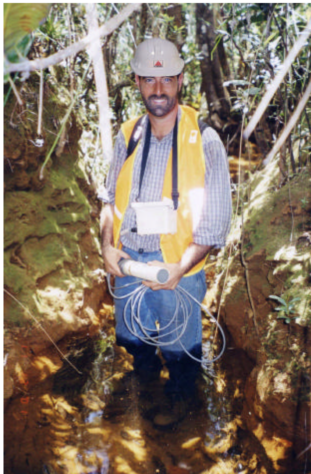
Photo 10: Mesure des paramètres physico-chimiques dans le ruisseau de l'aire de stockage est des morts-terrains durant la saison sèche (déc.2001)
