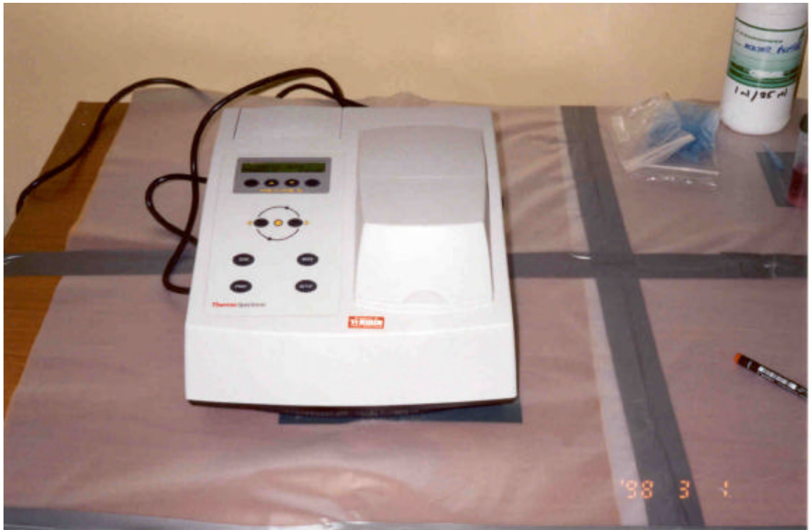
Photo 3 : Spectrophotomètre utilisé sur le terrain pour les analyses du bromure
