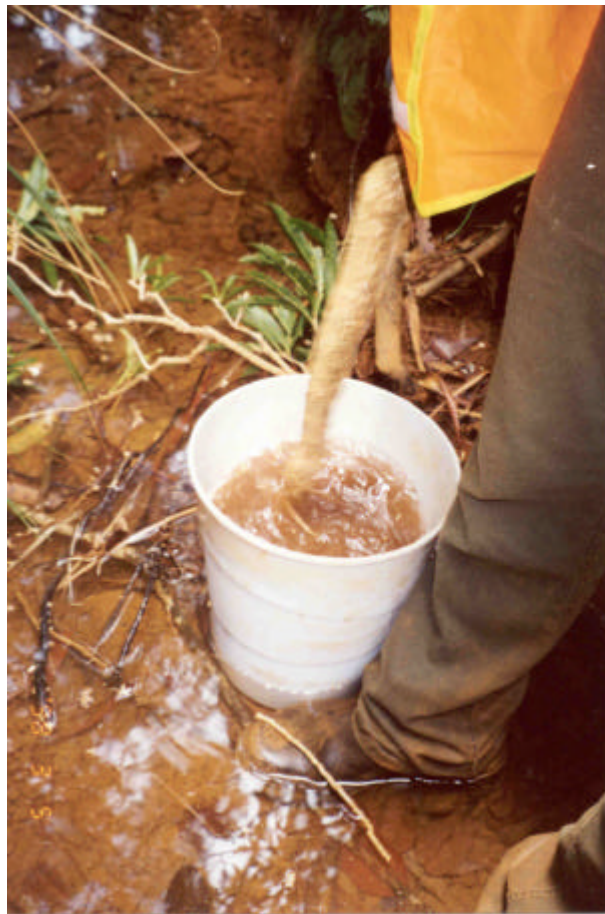
Photo 20: Mélange de la solution de bromure de potassium (déc.2001)
