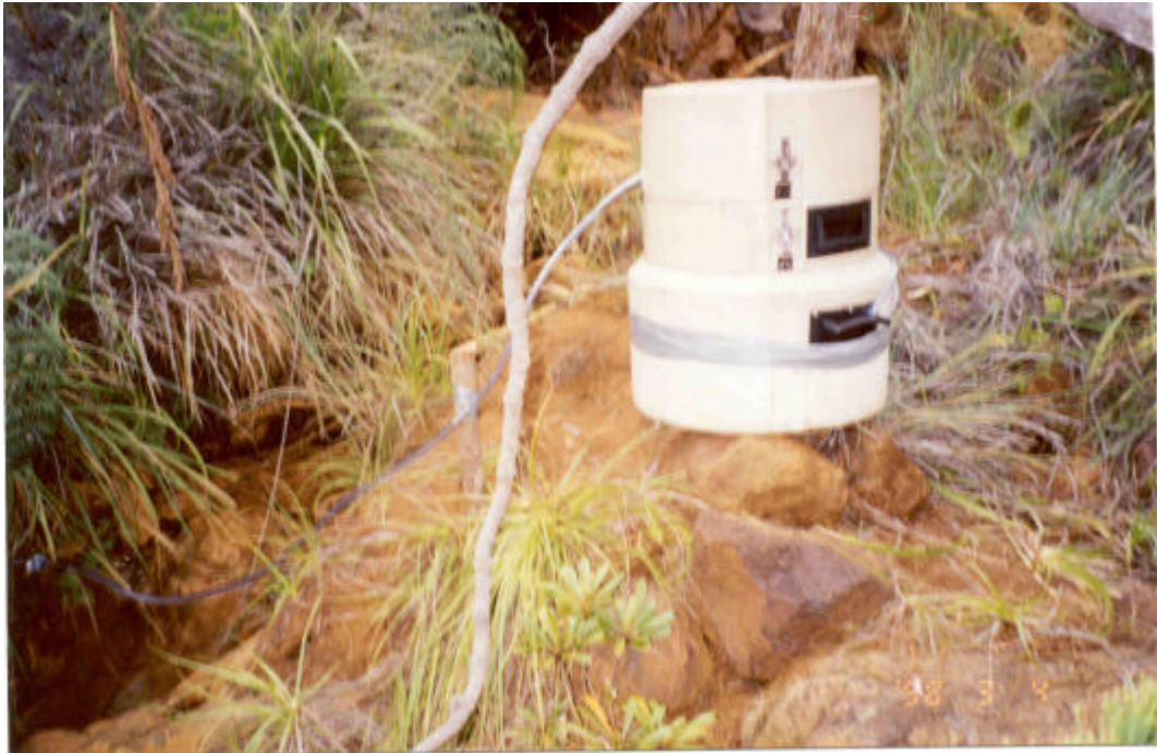
Photo 13: Echantillonneur automatique installé sur un ruisseau s'écoulant vers la rivière Wajana (station d'échantillonnage TT-SW1) (déc.2001)
