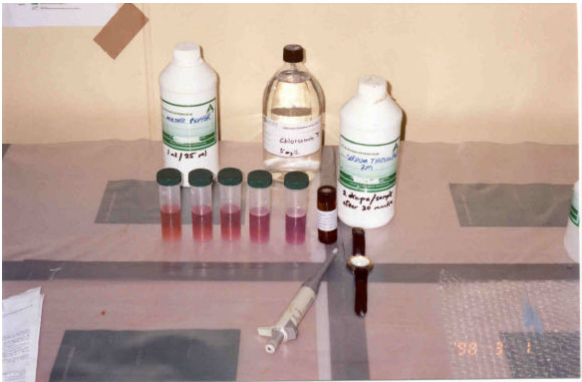
Photo 2: Réactifs et solutions de calibration utilisés pour les analyses du bromure sur le terrain
