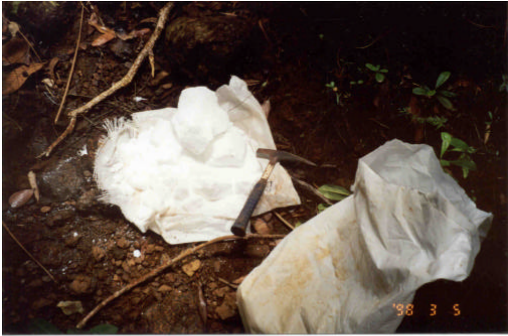
Photo 19: Préparation du sel de bromure de potassium avant mélange (pulvérisation) (déc.2001)
