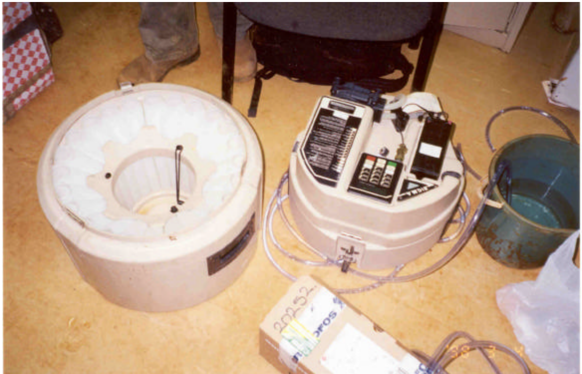
Photo 1: Echantillonneur automatique : afficheur, clavier, pile et carrousel de bouteilles
