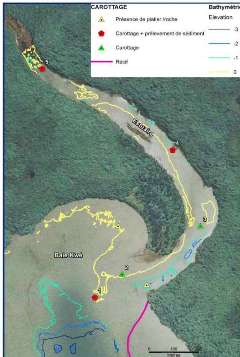
Figure 39 : Stations de carottage et de prélèvement de sédiment en 2013 (Littoralys 2014)
