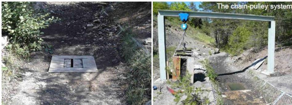
**Figure 24 : Trappe à sédiment et dispositifs de relèvement (photos : F.Liebault)**
