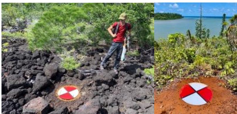
**Figure 13 : Points de contrôle au sol (GCP) (Source : ECOTONE)**
