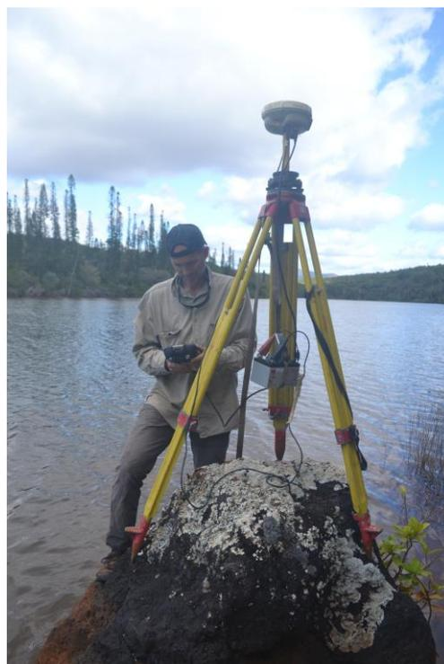
**Figure 5 : Vue de la base GPS (localisation « Kwé ») (Source : SEACOAST)**
