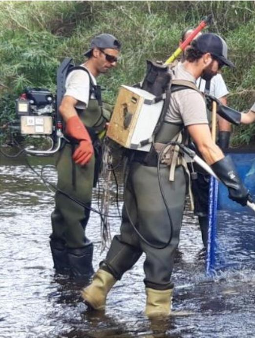
*Photos 4 : Aperçu des deux appareils : à gauche l'EFKO FEG-1500 (en attente) ; à droite le Martin-Pêcheur en action de pêche*
