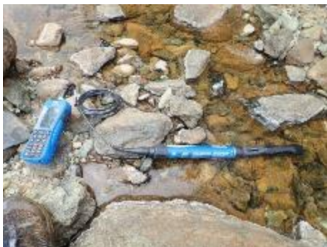
Figure 2 : illustration de la sonde multi paramètres HL4.
