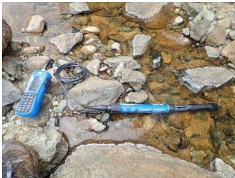
Figure 3 : illustration de la sonde multi paramètres HL4.
