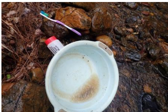
Figure 4 : illustration du matériel de prélèvement pour les diatomées.
