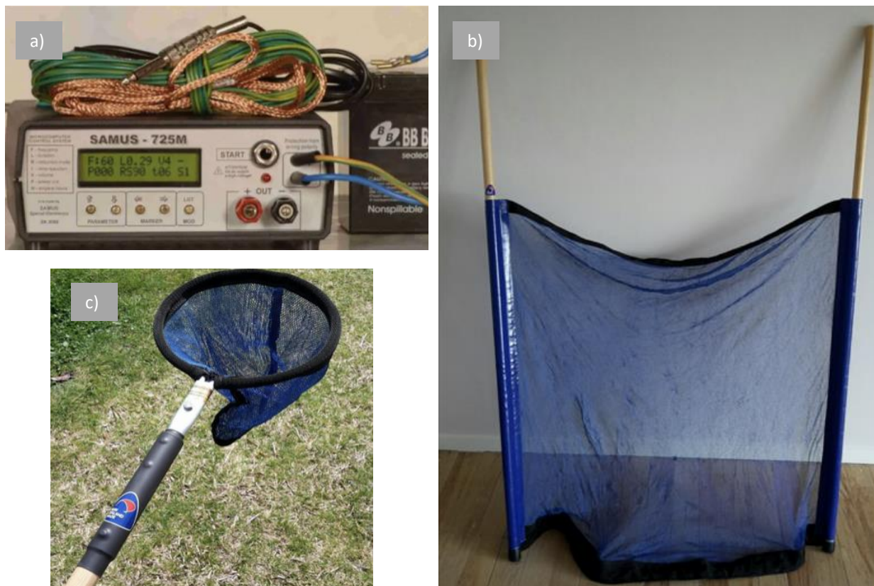
Figure 1 : Photographies du matériel utilisé dans le cadre de la pêche électrique a) Appareil SAMUS portable sur batterie 12V de la marque Electrofisher, b) Filet stopnet maille 3 mm, c) Épuisette diamètre 20cm/maille 3 mm (© Nicolas Charpin).
