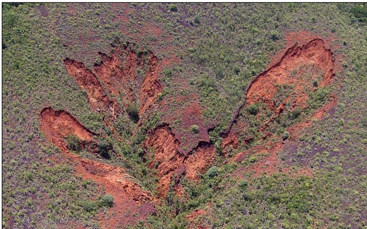
Figure 1 : Cellules de lavakas développées dans les latérites et sur péridotites - Massif de Téné (Source : Geo.impact)
