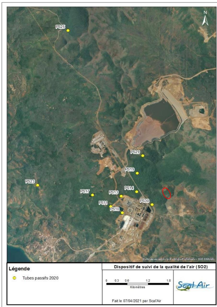
Figure 47 : Localisation des tubes passifs pour l'analyse du SO<sub>2</sub> comparée à la zone de dépérissement Est (en rouge)
