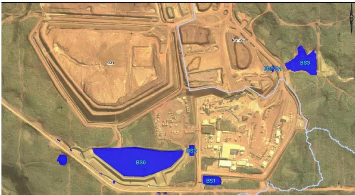
Figure 129 : Gestion des eaux pluviales internes à l'UPM-CIM – zoom sur les bassins de sédimentation de l'UPM-CIM - extrait de la demande d'autorisation d'exploiter de la mine 2016.
