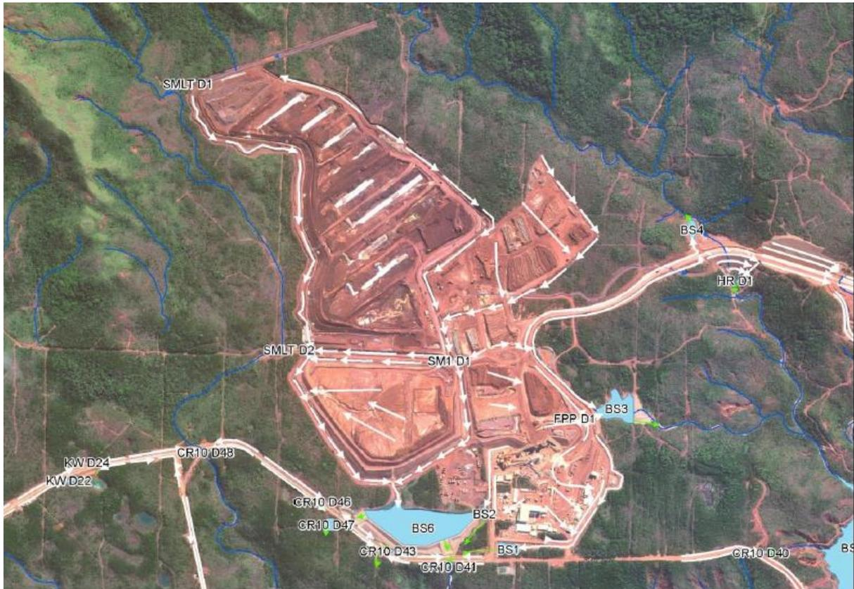
Figure 130 : Gestion des eaux pluviales de l'UPM-CIM – flux d'eaux sales (flèches blanches) et flux d'eaux traitées (flèches vertes) en 2014 - extrait de la demande d'autorisation d'exploiter de la mine 2016.
