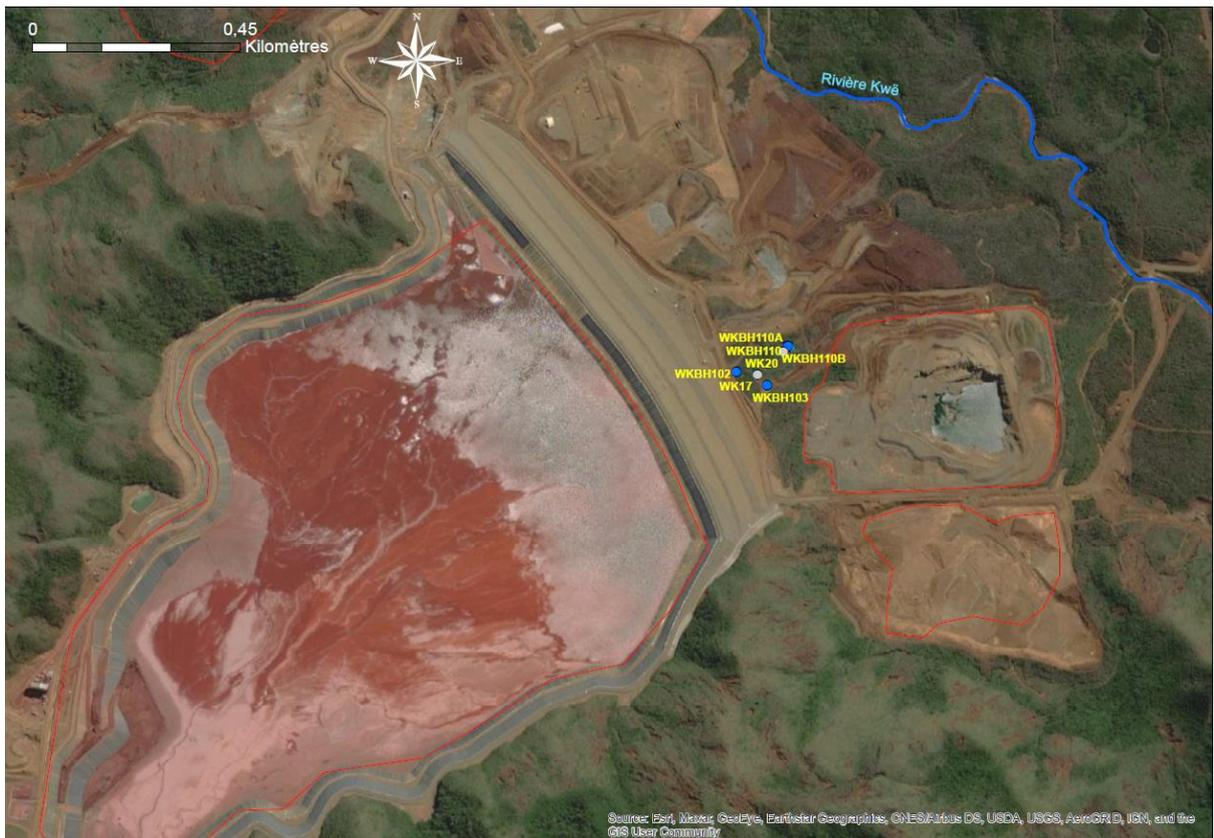
Figure 65 : Localisation des sources et piézomètres les plus fortement perturbés (Conductivité, Sulfates et éléments majeurs) situés à l'aval de l'ASR - Source OEIL.
