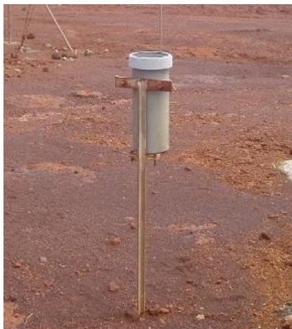
Figure 4 : Dispositif de collecte des eaux de pluie
