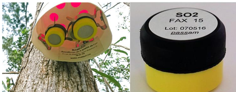
Figure 1: Dispositif de mesures passives du \text{SO}_2 par tubes Passam Ag
