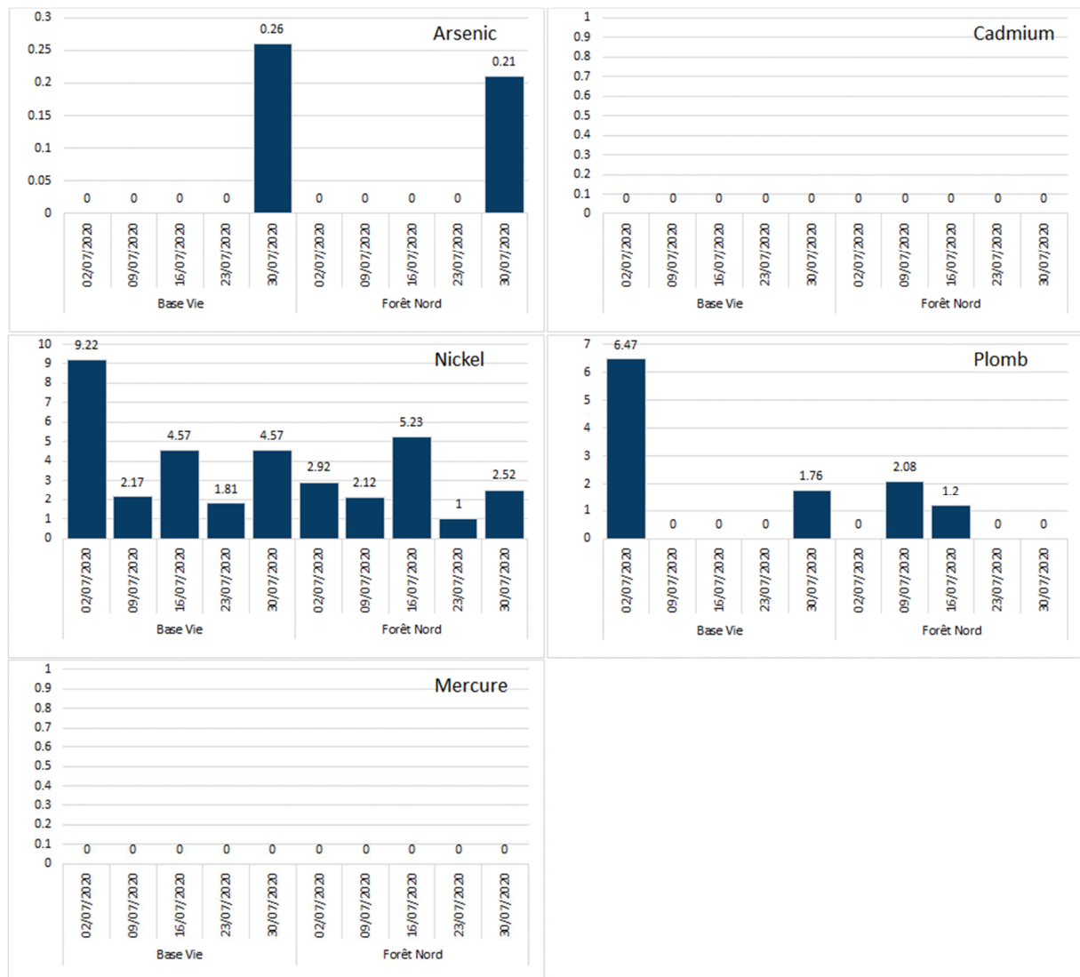
Figure 15 : Métaux contenus dans les poussières en suspension (PM 10 ) pour les stations Forêt Nord et Base-vie en 2020
