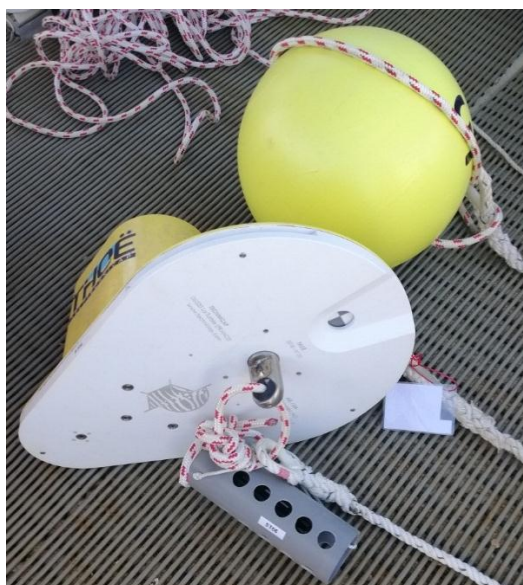
Figure 2. THOË recevant les DGTs et enregistreur de température associé.
