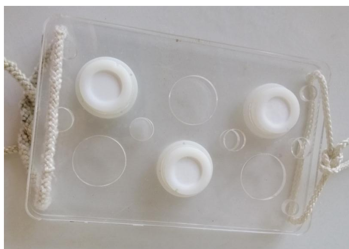
Figure 3. DGT déployés sur chaque site d'échantillonnage (avant déploiement)
