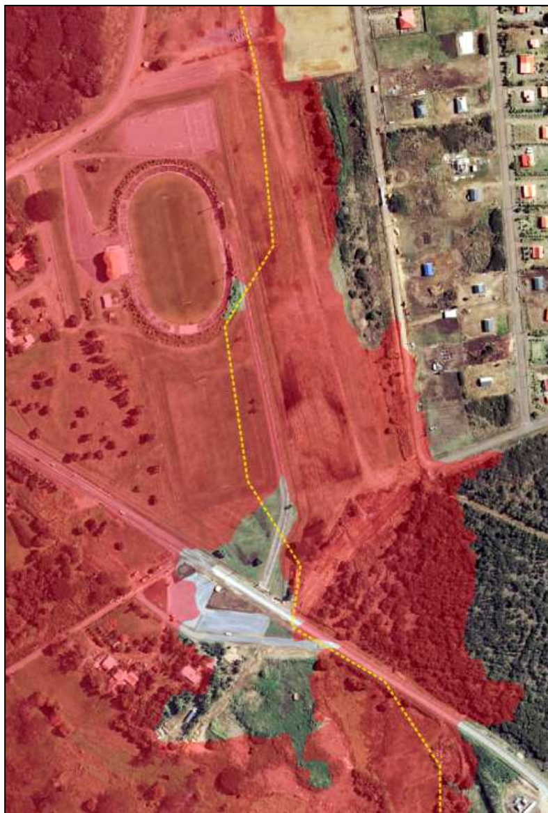
Figure 85 : Augmentation de la zone inondée cartographiée pour la crue centennale (en jaune limite de l'ancienne zone inondable – en rouge la nouvelle zone)
