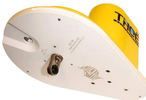
Photographie de la face inférieure du THOË permettant de voir la fenêtre d'exposition du DGT™.
