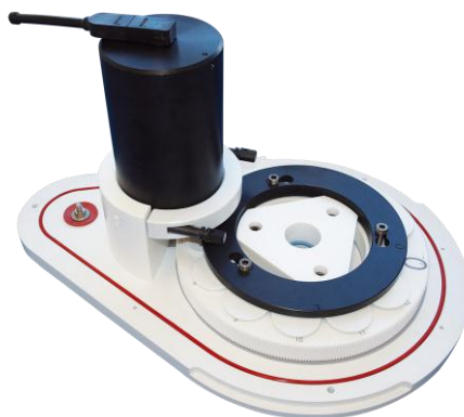
Photographie du plateau rotatif du THOË pouvant accueillir jusqu'à 12 DGT™.
