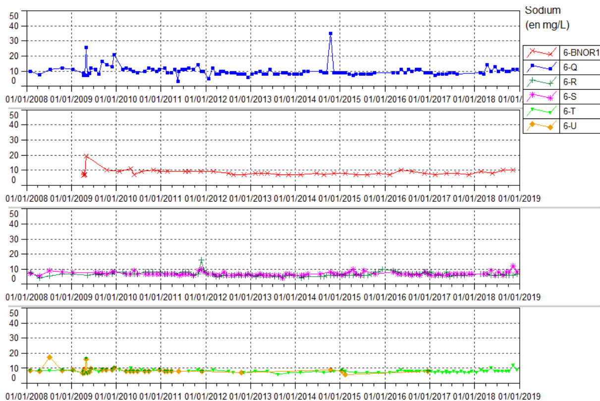
Figure 10 : Concentration en sodium pour les stations 6-Q, 6-BNOR1, 6-T, 6-U, 6-S et 6-R entre janvier 2008 et janvier 2019
