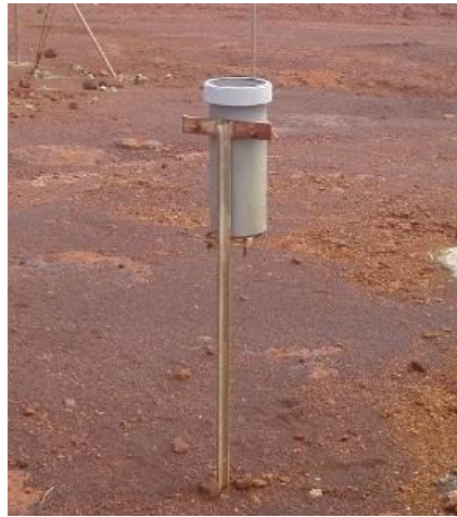
Figure 2 : Dispositif de collecte des eaux de pluie
