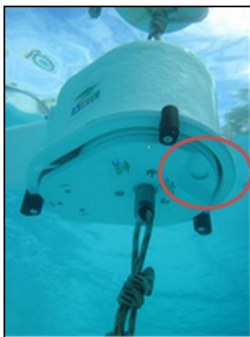
Figure 3 : Photographie d'un passeur de DGTs "THOË" immergé avec sa fenêtre d'exposition (cercle rouge).
