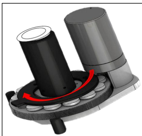
Figure 4 : Schéma du plateau rotatif entraîné par un moteur programmable.
