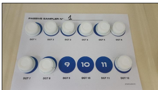
Figure 6 : Identification et observation des DGTs en laboratoire (sous hotte à flux laminaire).
