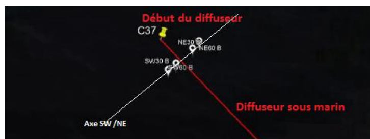
Figure 10 : Poition des automates immergés pour un suivi en champ très proche du diffuseur
