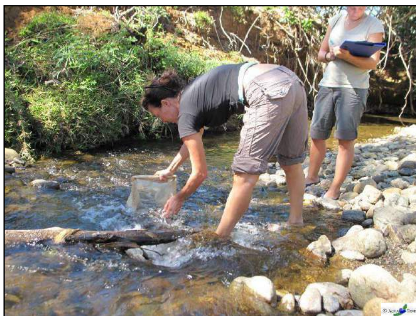
Figure A : Schéma de principe et photographie sur le terrain de prélèvement de macrofaune benthique avec l'échantillonneur de type « Surber »
