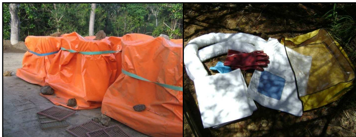
Photo 8 : Fûts sur bacs de rétention recouverts de bâches, à gauche et kit anti-pollution, à droite.
