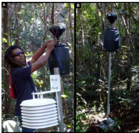
FIGURE 3. A. ILLUSTRATIONS DU DISPOSITIF METEO, ET B. DE JAUGE OWEN, SUR TRANSECT 2 (FORMATION PARAFORSTIERE; ©IAC/ C. ZONGO).
