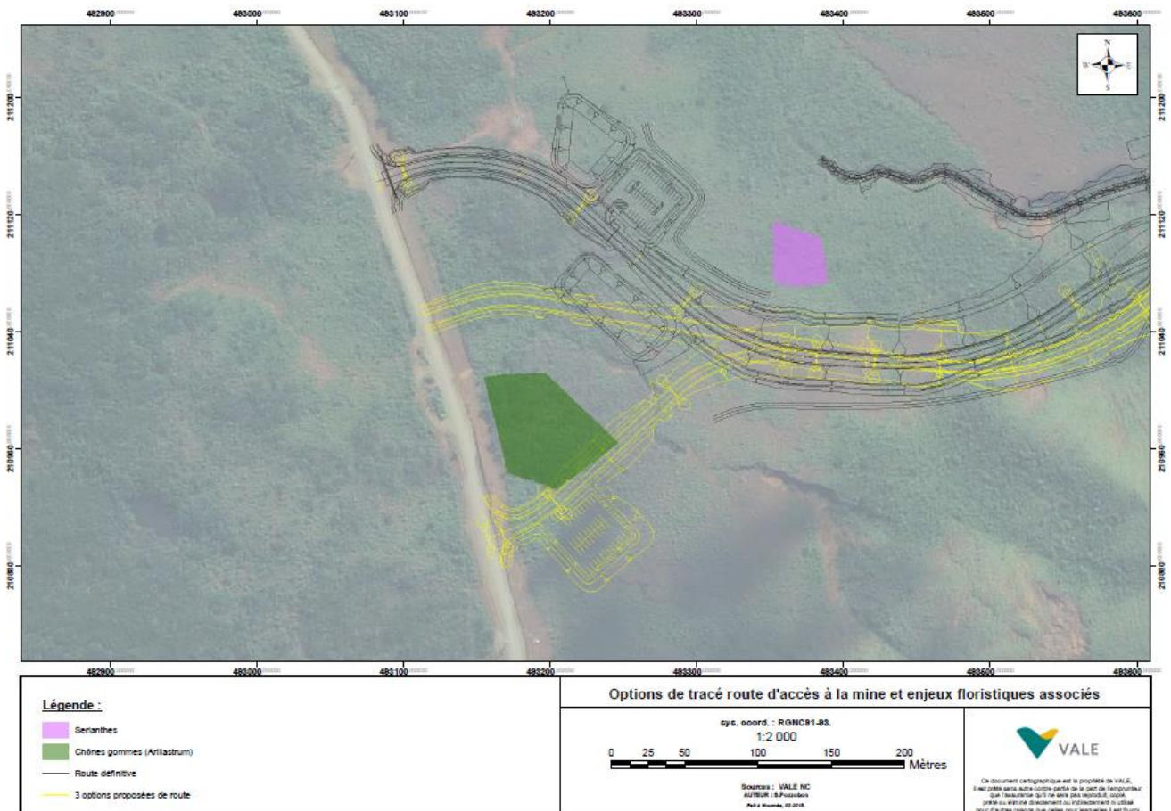
Figure 6 : Localisation du lambeau de maquis paraforestier à Arillastrum et peuplement de Serianthes petitiana en bord de CR7 par rapport au plan de terrassement original de la route (en jaune) et plan retenu pour éviter ses deux zones (en noir).
