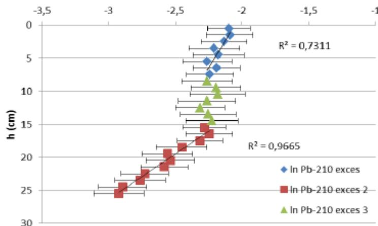
Le premier épisode est constitué par les horizons de 0 à 8 cm, il présente un taux de décroissance radioactive rapide et équivaut à un taux d'accumulation de  $1,23 \text{ g/cm}^2/\text{an}$  ( $R^2=0,780$ ).
