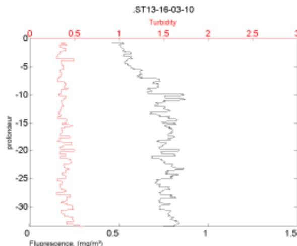
La figure ci-dessus indique que la turbidité et la fluorescence ont été enregistrées par une sonde multiparamétrique, entre 0 et 36 m de fond, (à -37 m le fond du lagon est atteint), sur la station St13 le 16/03/2010 (pour cet exemple) ; l'état de la marée et la pluviométrie au moment précis de ces
