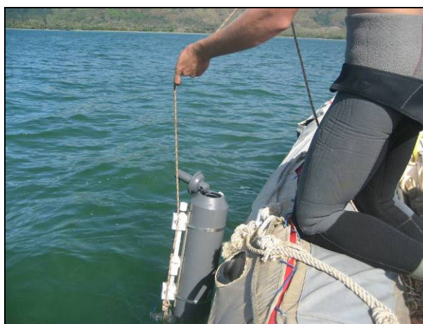
Figure 9 : Echantillonneur 5 litres pour les prélèvements d'eau
