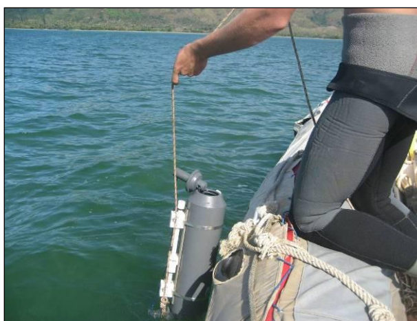
Figure 2 : Echantillonneur 5 litres pour les prélèvements d'eau
