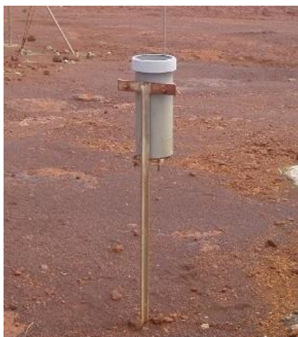
Figure 2 : Dispositif de collecte des eaux de pluie
