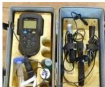
Figure 2: Sonde multiparamétrique Hach HQ40D.
