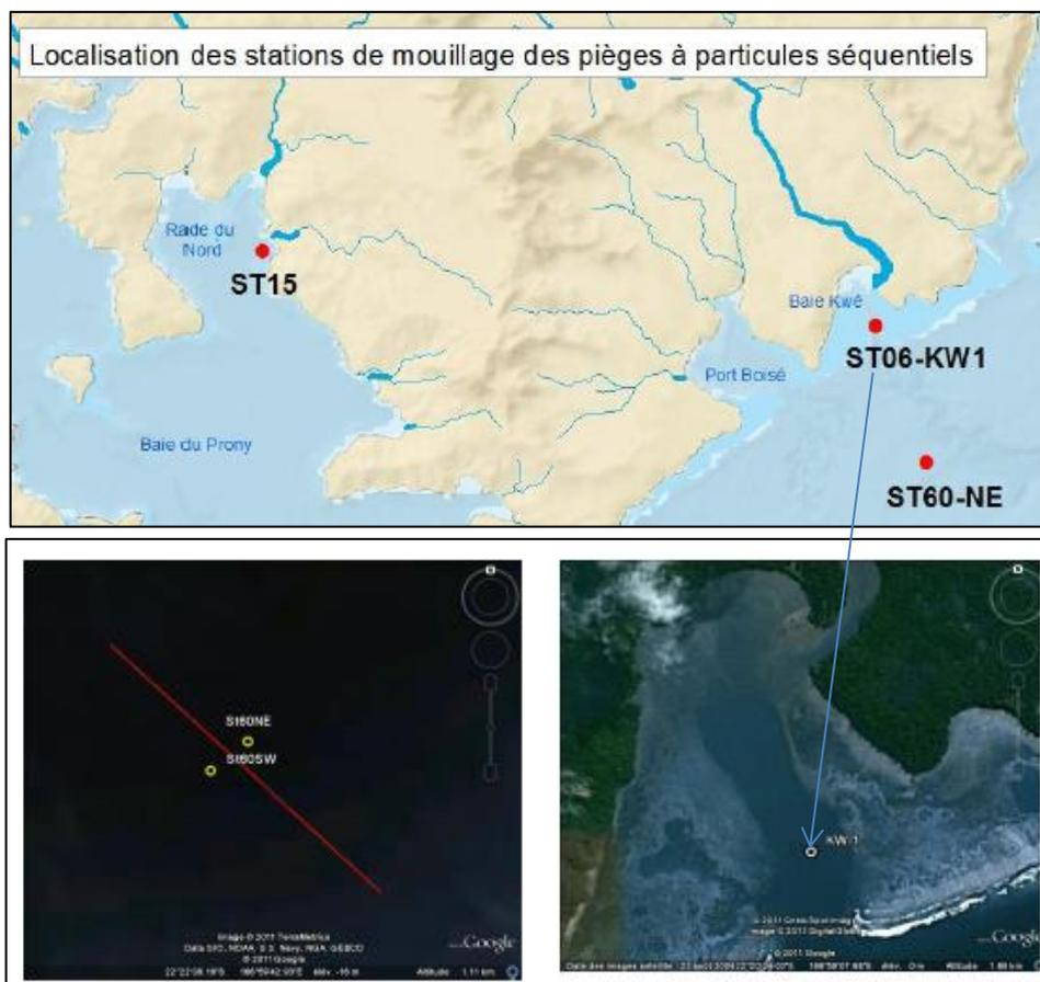
**Le dispositif de collecte des flux de MES est placé à 3 mètres au-dessus du fond.** Cette cote de profondeur est particulièrement importante à respecter pour les pièges mouillés à proximité du diffuseur afin que les orifices de collecte demeurent en contact avec l'effluent, même lorsque les conditions hydrodynamiques des marées de vive-eau s'exercent.
