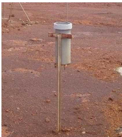
Figure 2 : Dispositif de collecte des eaux de pluie
