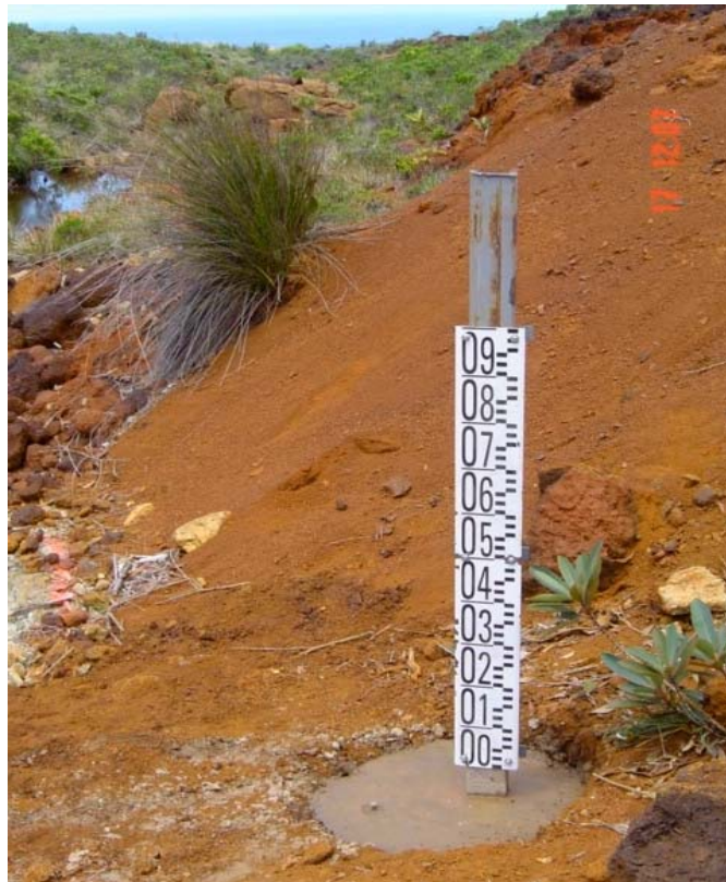
Echelle limnimétrique E3 (2 à 3 m) installée en amont de E1 (rive droite)
