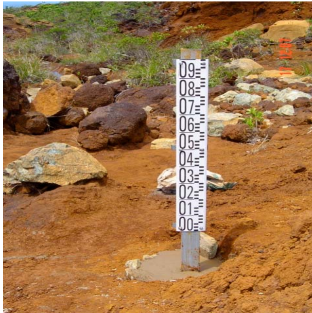
Echelle limnimétrique E2 (1 à 2 m) installée en amont de E1 (rive droite)
