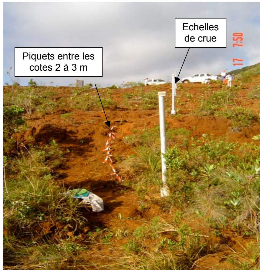
Echelles de crue du site KAL et piquets espacés tous les 10 cm entre les cotes 2 à 3 m
