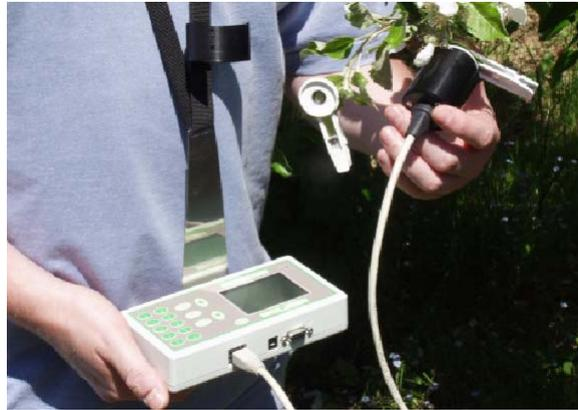
Aspect du "Plant Efficiency Analyser Meter" : un outil léger et performant
