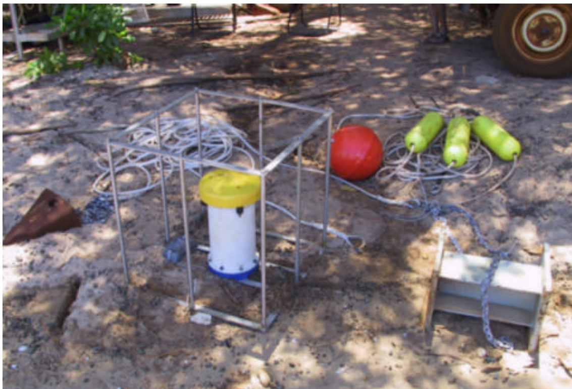
Schéma 4.2: Photo du compteur de mesure du courant dans sa structure, cordes d'amarrage, bouées et poids.
