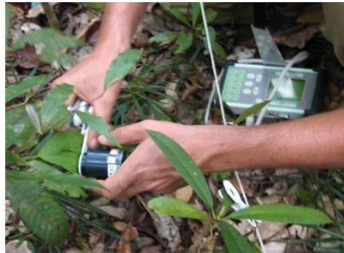
Figure 3 : Mesure de fluorescence chlorophyllienne avec un fluorimètre portable
