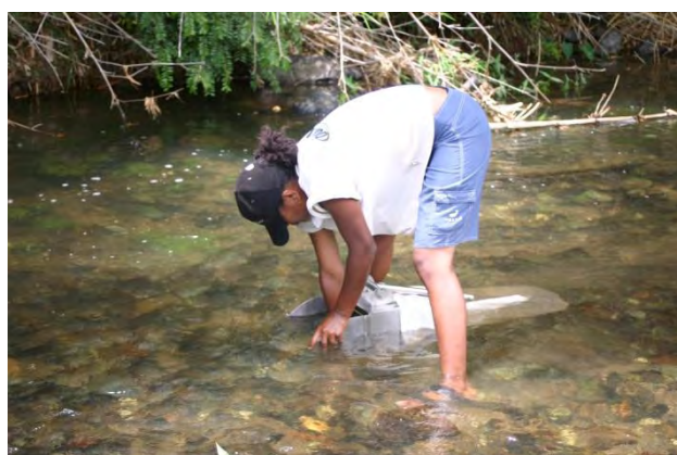
Photographie 1: Prelevement de macroinvertébrés a l'aide d'un filet surber
