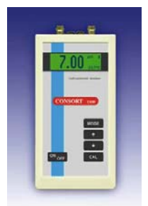
Figure 2 : Sonde multiparamétrique de terrain (Consort 535)
