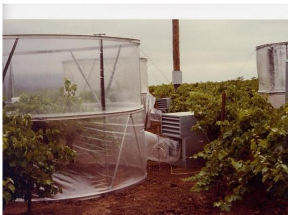
Figure 2 : Dispositif de la tonnelle montrant le système de ventilation et d'alimentation en SO<sub>2</sub>
