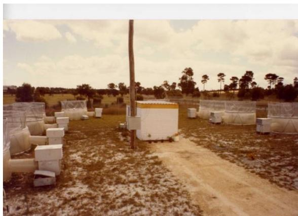
**Figure 1 : Dispositif technique montrant les tunnels verticaux et le local contenant les appareils de dosage de SO<sub>2</sub> et les détecteurs (Australie occidentale)**
