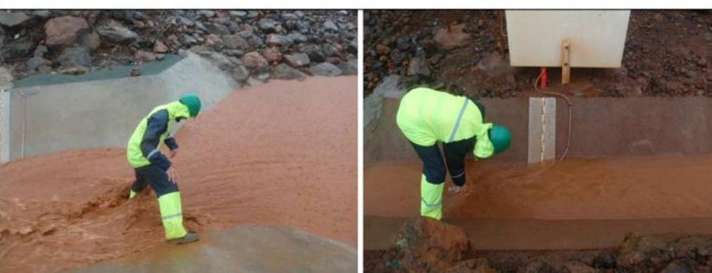
A gauche: Seuil aval pendant une crue, franchissement difficile. A droite: Prélèvement d'eau manuel au seuil amont.
