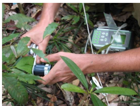
Figure 11 : Mesure de fluorescence chlorophyllienne avec un fluorimètre portable
