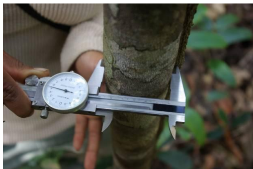
Figure 8 : Mesure de diamètre avec un pied à coulisse
